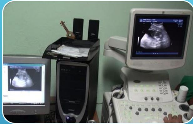
El equipo de Ultrasonido transmite imágenes a través de tarjeta capturadora USB hacia la computadora.
